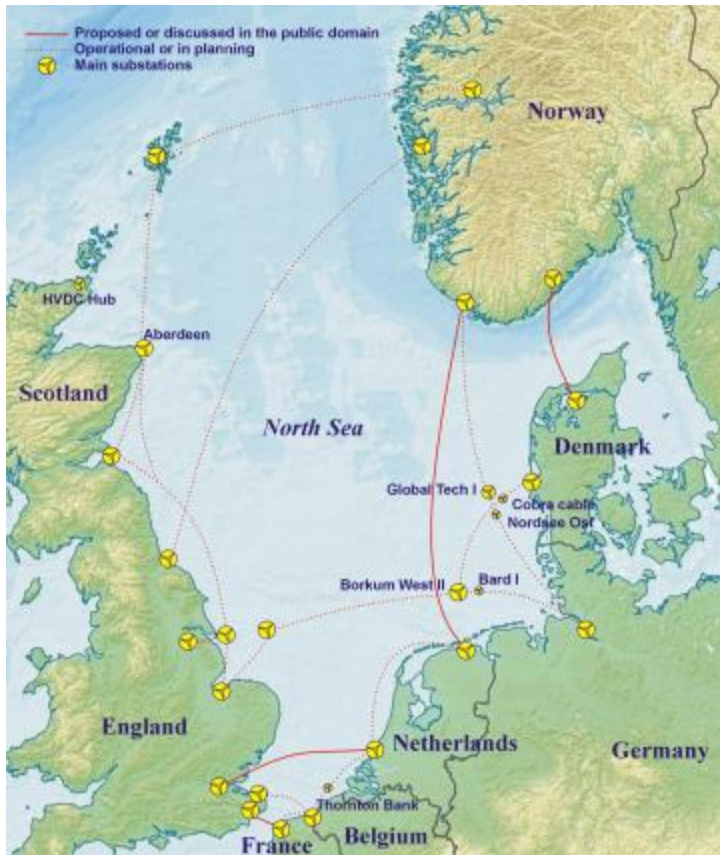
Hình 5: Đường dẫn HVDC được đề xuất ở Biển bắc, kết nối các nhà máy điện gió trên bờ và liên kết với các quốc gia châu Âu [12]
